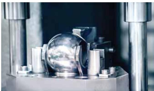
Высокое качество шаровых кранов LD обеспечивает максимальный класс герметичности затвора «А» по ГОСТ 9544. В зависимости от исполнения шаровые краны LD могут быть использованы как в умеренном, так и в холодном климате (У категории и ХЛ категории по ГОСТ 15150).
